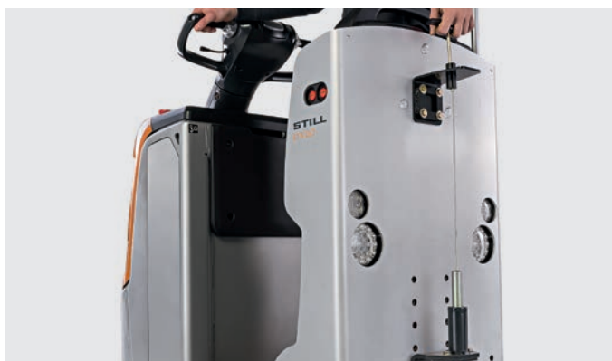
Desenganche rápido del acoplamiento desde el puesto de conducción 1
