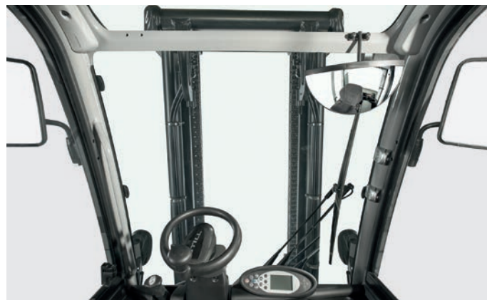
Siempre la mejor visión de la carga y las horquillas gracias a perfiles de mástil estrechos
