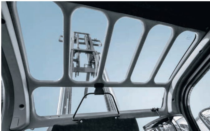
Máxima visibilidad gracias a las numerosas ventanas y los perfiles estrechos del tejadillo protector
