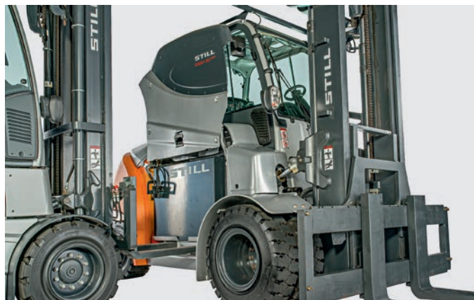
Elevada disponibilidad gracias al rápido cambio de la batería
