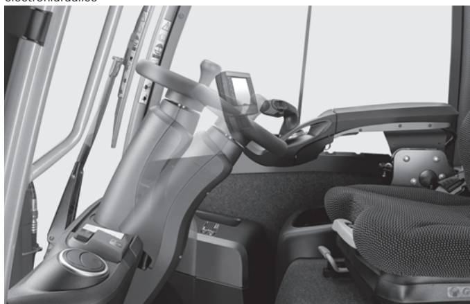
Ajuste personalizado de la columna de dirección
