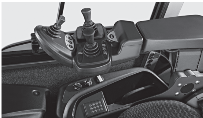
Control hidráulico sensitivo y varios compartimientos de almacenaje
