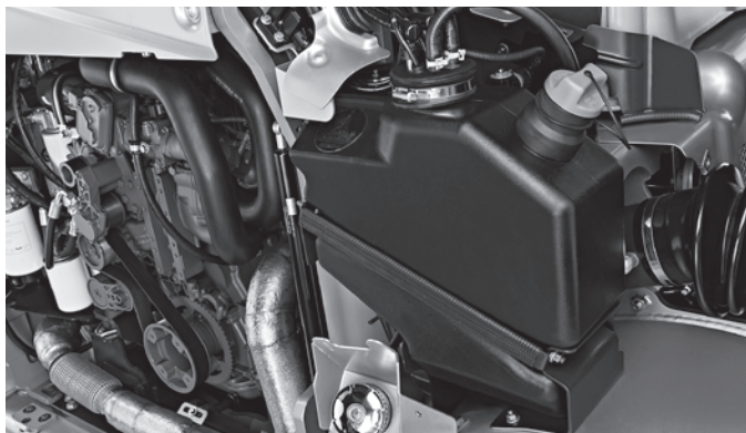
Depósito AdBlue para el post-tratamiento de gases de escape
