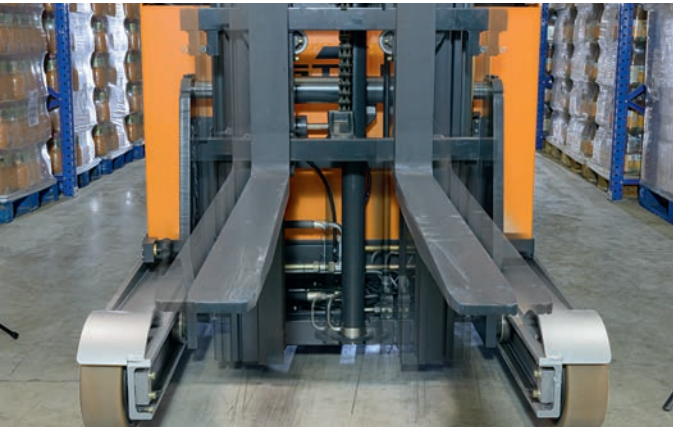
Gran visibilidad de las cargas gracias al exclusivo desplazamiento lateral de mástil
