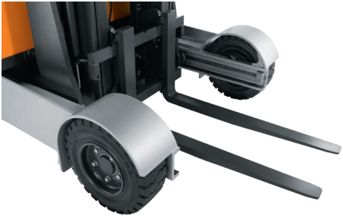
Ruedas súper elásticas con protección para mayor seguridad
