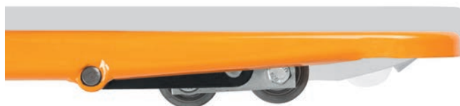
Opción de elevación de palés especiales extremadamente bajos con las horquillas planas de la HPT 20 FL
